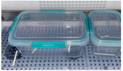
Des bandelettes réactives à l'acide peracétique sont placées à l'intérieur et à l'extérieur des conteneurs
