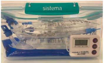
Un thermomètre avec sonde externe est introduit dans le conteneur au milieu de plaques eutectiques avec des poches de NaCl et des flacons d'eau
