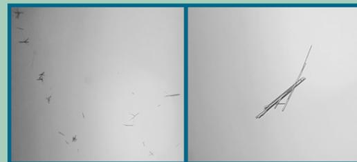
Fig. 1: Cristaux observés au microscope après 7 jours dans les solutions de haute concentration
