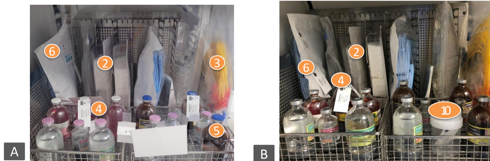
Photos : Distribution de la charge dans le SAS de stérilisation test 1 (A) et test 2 (B)
